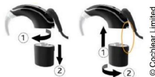
**Sostituire le batterie ricaricabili:** ruota e rimuovi la batteria dal processore e collegala al caricabatterie fino a quando il LED diventerà verde.
